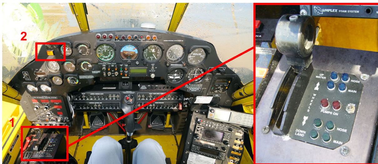
Figura 2. Situación de indicaciones visuales del tren en la cabina del AT802A
