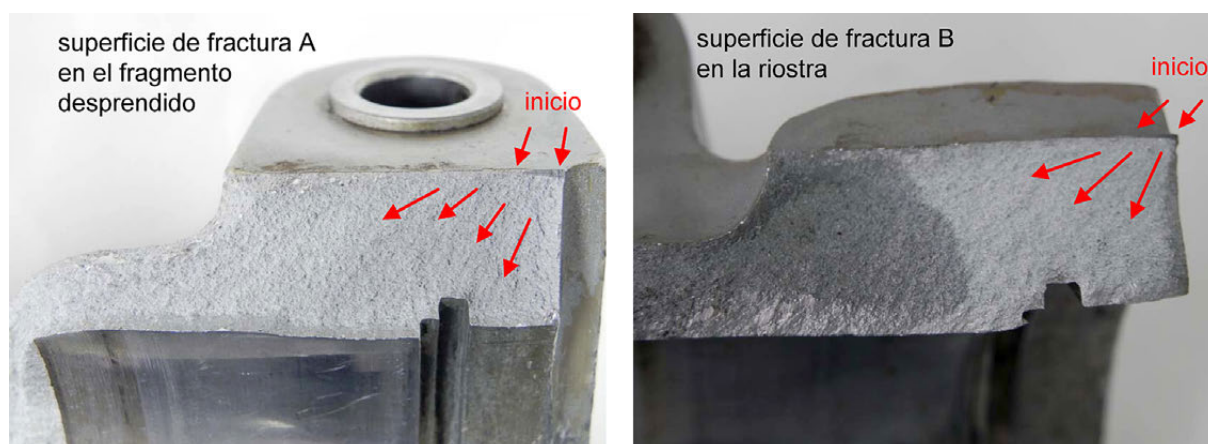
Figura 5. Detalle fracturas A y B
