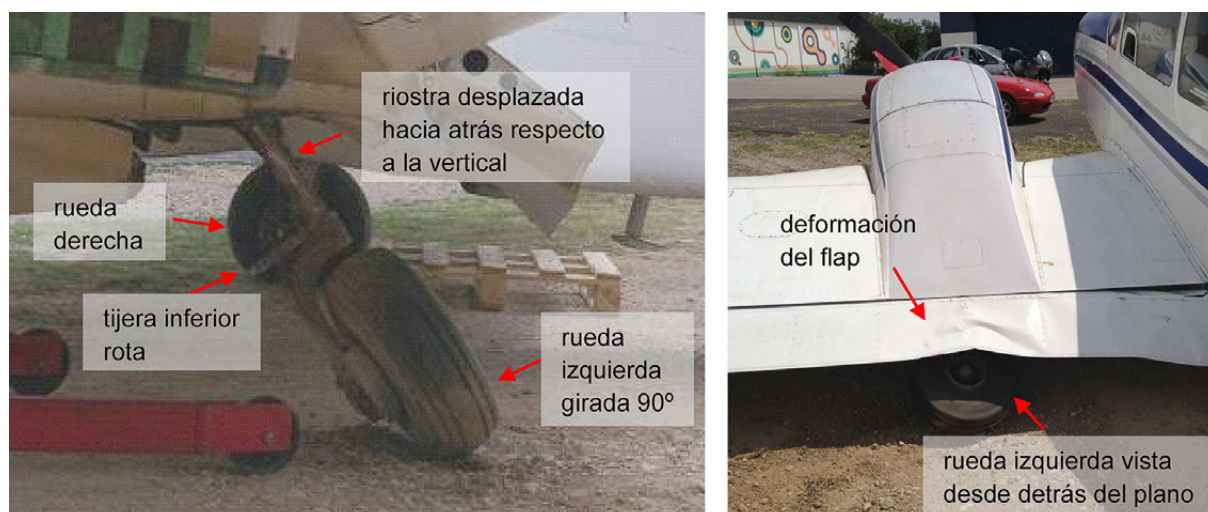
Figura 3. Tren izquierdo visto desde la punta (izda.) y borde de salida (dcha.) del plano izquierdo
